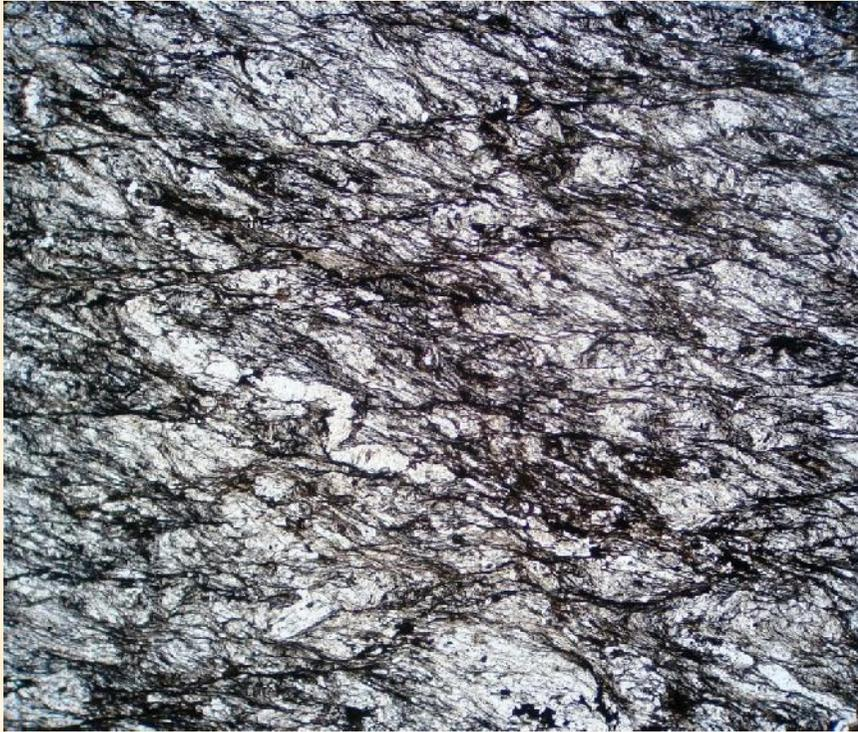
Quartzo-xisto do Complexo Setuva (PR). A assimetria das shear-folds indica um movimento dextrógiro. Foto: E. Salamuni
